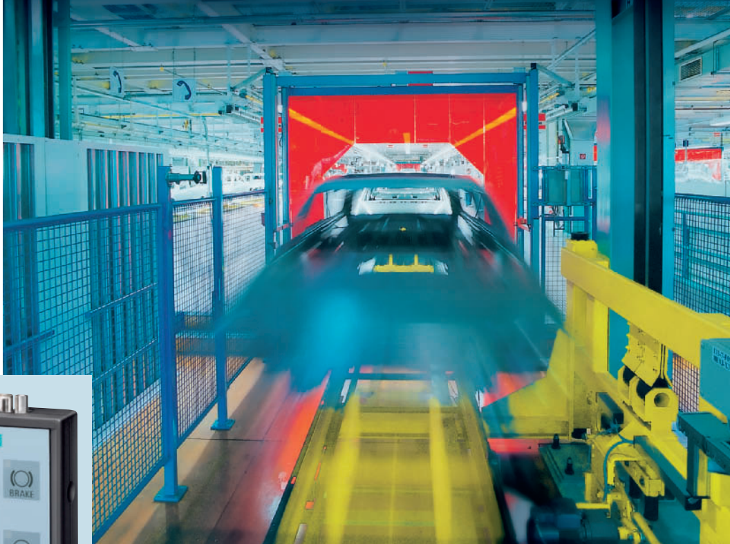
Oben: Förderanlage in der Automobilindustrie – Durch Dezentralisierung können einzelne Abschnitte umfangreicher Förderanlagen unabhängig voneinander in Betrieb genommen und gewartet werden. Links: Einfache Bedienung – Das Handbediengerät ermöglicht den direkten Zugriff auf dezentrale Motorstarter von Siemens.
