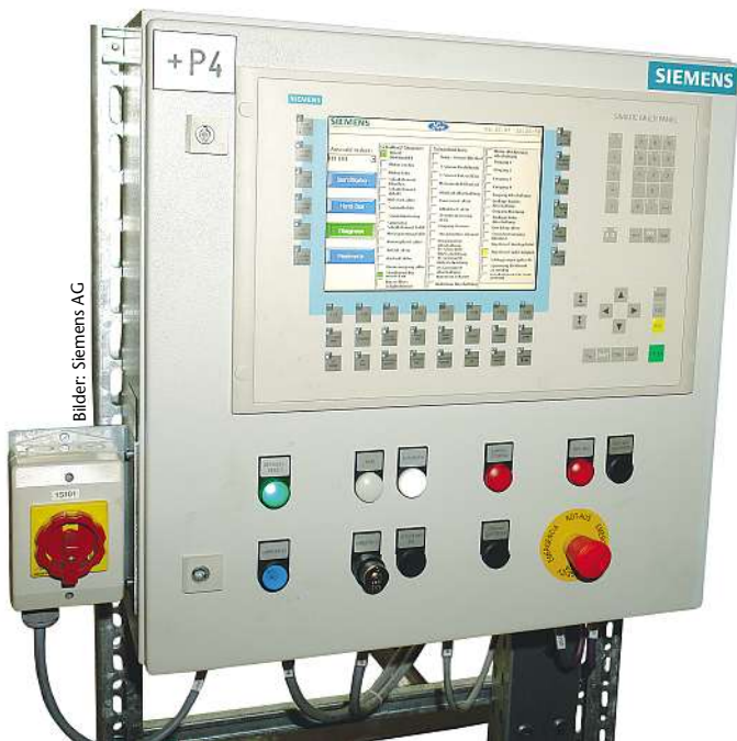
Bild 2: Am Operator Panel MP 270 lassen sich alle Betriebs- und Diagnosewerte übersichtlich darstellen. Damit müssen die Instandhalter nicht mehr in die Anlage gehen, um über alles Bescheid zu wissen.
