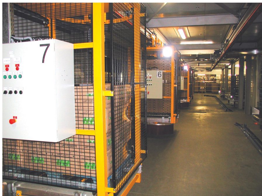
Bild 1. Jeder Motorwagen ist mit einer Simatic S7-Steuerung ausgestattet und kommuniziert über Profibus-DP mit der Anlagensteuerung. Dies ermöglichte ATS, die gesamte Systemsoftware im Voraus zu testen und den Betrieb zu simulieren
