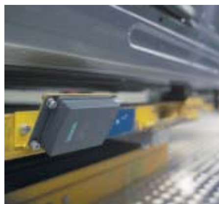
Das RFID-System Moby U speichert alle für die Produktion des Fahrzeugs relevanten Daten
