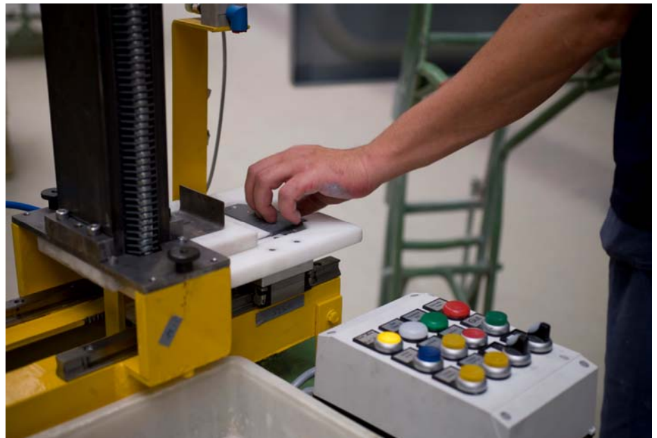
Während des Einbrennens der emaillierten Beschichtung werden die Daten per Software mitgeführt. Anschließend erhält jede Wanne bzw. Duschfläche einen neuen Tag – im Bild die manuelle Schreibstation.
