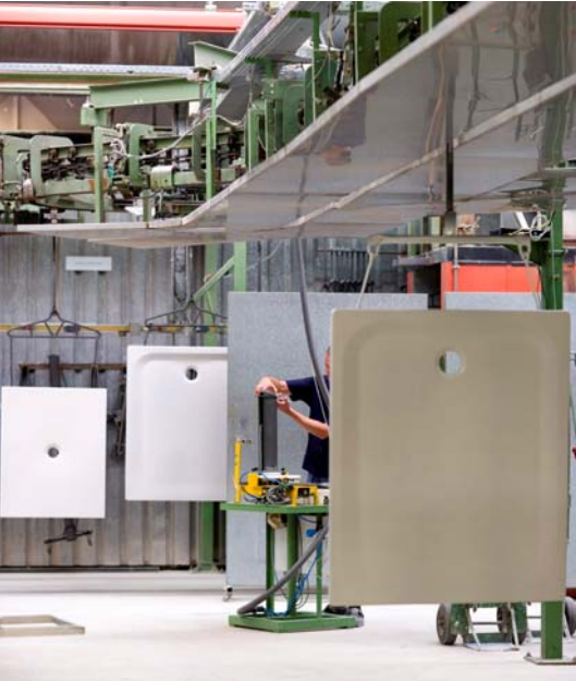
Alle Bearbeitungsschritte werden über das RFID-System RF300 kundenindividuell vorgegeben und produktspezifisch erfasst.
