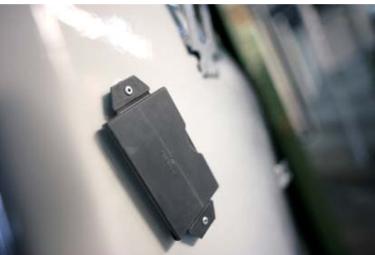
Ein Magnet sorgt für den sichereren Halt der scheckkartengroßen Datenträger RF360T am Produkt.
