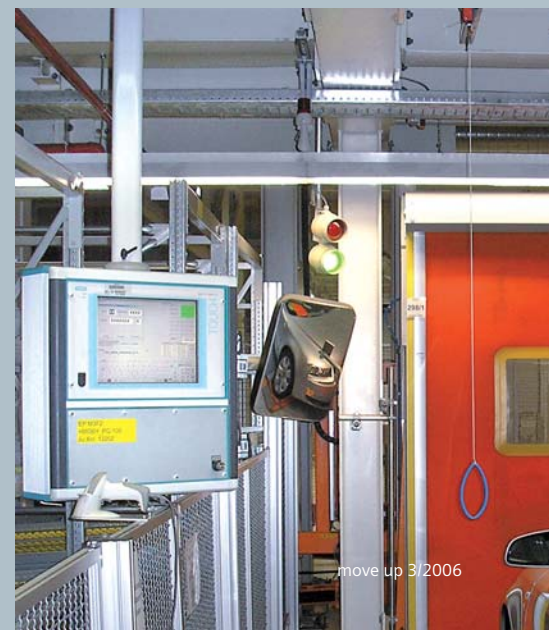
Fahrzeuganalyse: Einer von neun Simatic Panel PC 670 Touch zur Visualisierung der Montage
