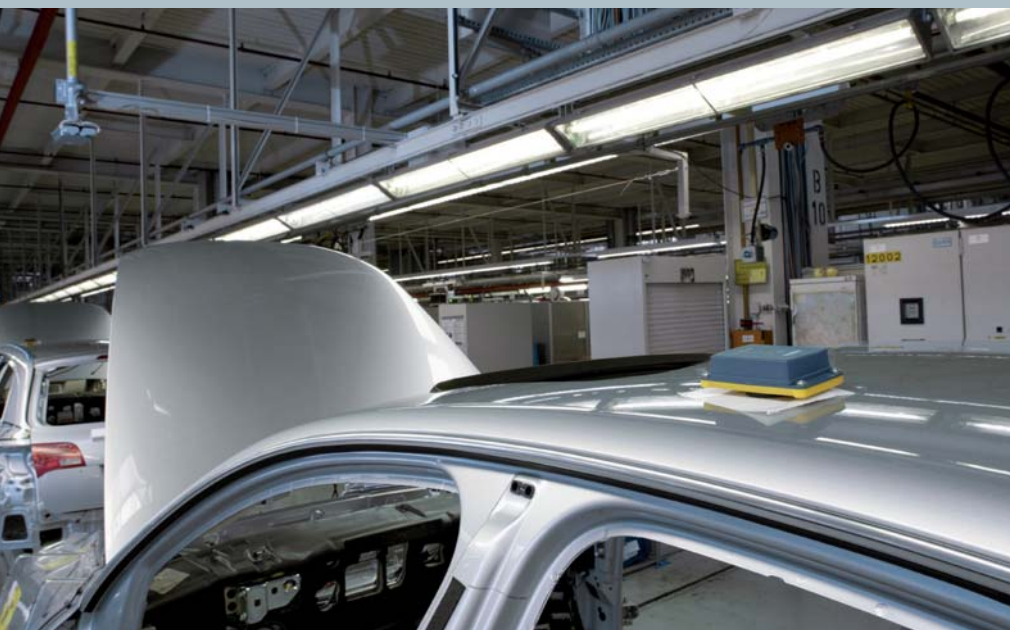
Gute Fahrt: Der mobile Datenspeicher MDS U315 begleitet den Audi A6 durch die gesamte Montage
