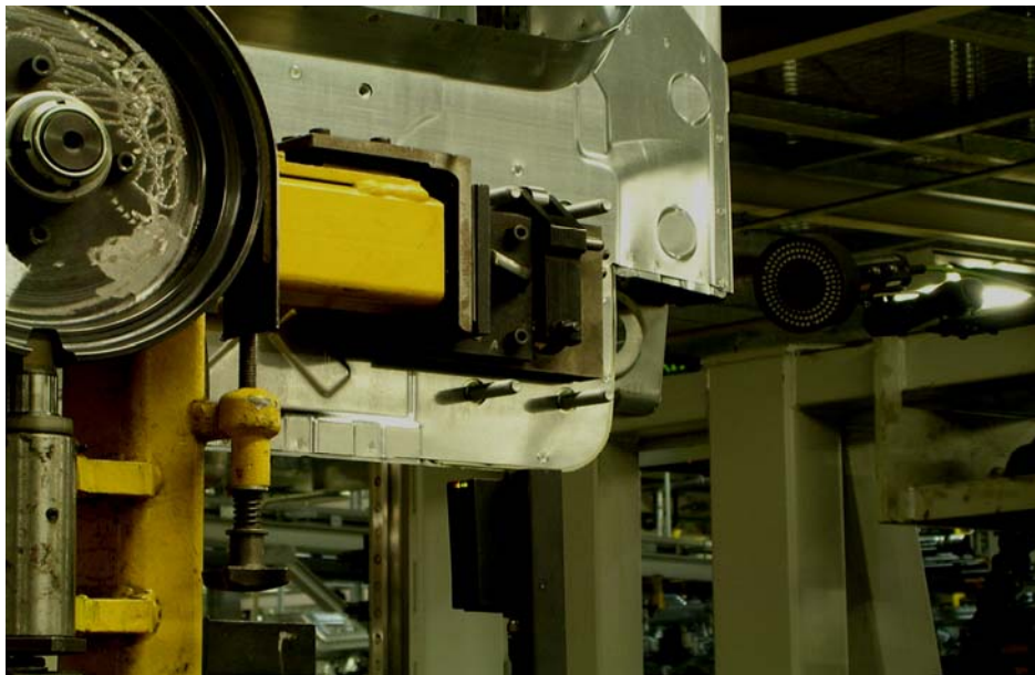
Einlesen, erkennen, weitermelden: Nur 0,5 s braucht der VS130-2, um den Data Matrix Code auf dem Bauteil zu lesen und auszuwerten.
