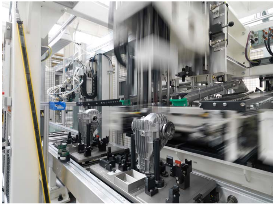
Getriebe auf Achse: Im Werk Baunatal fertigt Volkswagen bis zu 30 verschiedene Hinterachsgetriebetypen parallel unter Einsatz eines berührungslosen Identsystems Simatic RF300 von Siemens.
