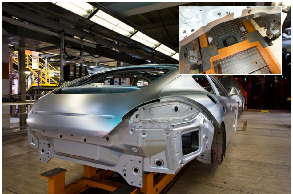
Neben dem VW Transporter T5 fertigt das VW-Werk Hannover auch die Rohkarosserien für den Porsche Panamera. Das Identifikationssystem Simatic RF300 von Siemens sorgt dafür, dass die richtigen Komponenten zur richtigen Karosserie verbaut werden.
