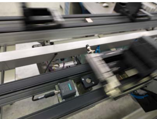
Bei Durchlaufgeschwindigkeiten von bis zu 16 m/min lesen die Reader einen Teil der gespeicherten Daten fliegend aus, um die Weichen für den weiteren Weg zu stellen
