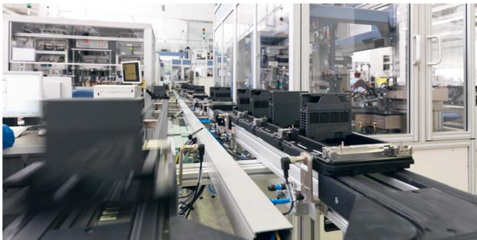
Auf der neuen Montagelinie ML S7flex fertigt das Elektronikwerk Amberg der Siemens AG künftig hoch flexibel über 100 verschiedene Baugruppen für die Steuerung Simatic S7-300.
