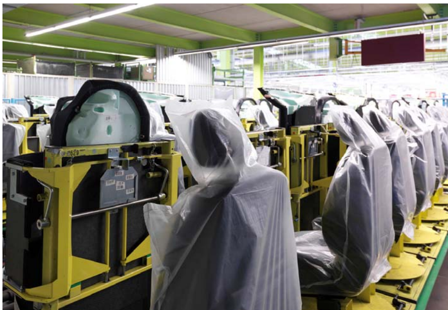
Just in sequence auf dem Verladendeck: Dank RF300-Codierung gelangen die Sitzgruppen in zahllosen Sitzvarianten sicher zum Einbau – exakt wie bestellt.
