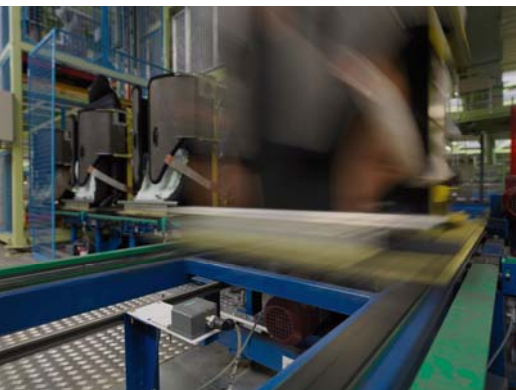
Der von Siemens in der Rollenbahn installierte Reader S740R identifiziert die Paletten für den Sitztransport...
