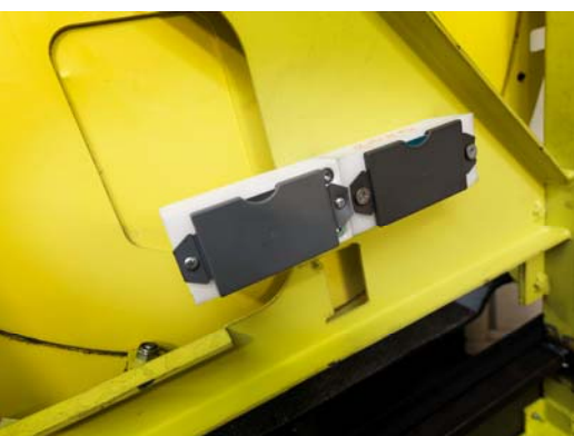
...anhand der unterseitig mitgeführten, auf Abstandhaltern montierten mobilen Datenspeicher Simatic RF360T (links; rechts das während der Umrüstungsphase noch benötigte Vorgängermodell).
