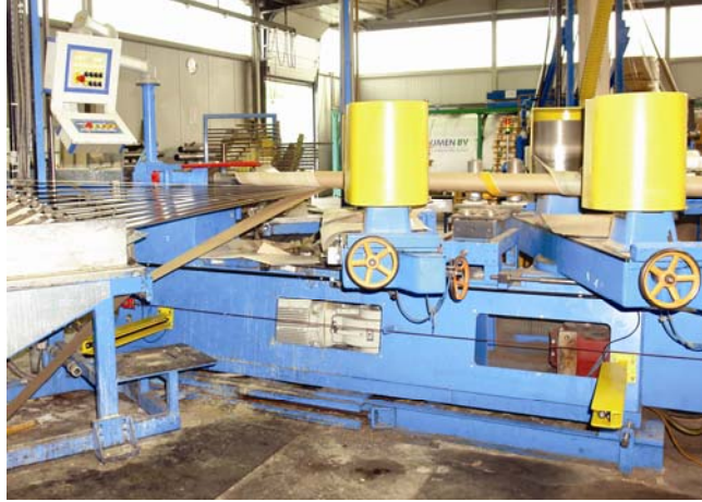
Abb. 1: Durch den Hintertrittschutz über die einfache Installation von Lichtgittern wurde eine zusätzliche Sicherheit für die Maschinenbediener erreicht
