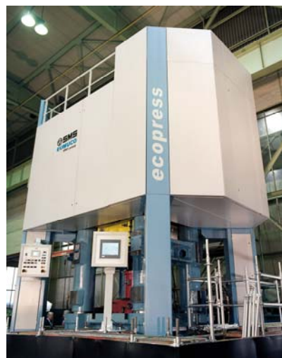
Abb. 2: Neuentwickelte Exzenter-Schmiedepresse EP 2500 von SMS Meer
