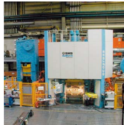
Abb. 4 : Schmiedelinie EP-Ecopress von SMS Meer
