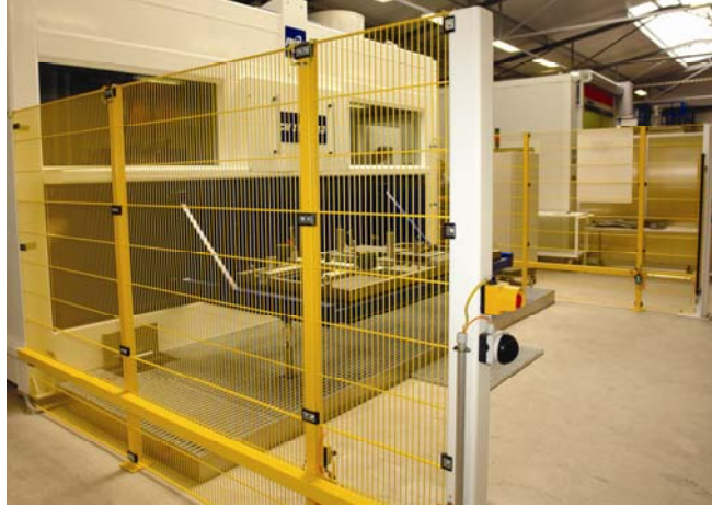
Abb. 1: Die neue Duojet-Wasserstrahl-Schneidanlage ist erstmals mit ASIsafe ausgerüstet worden
