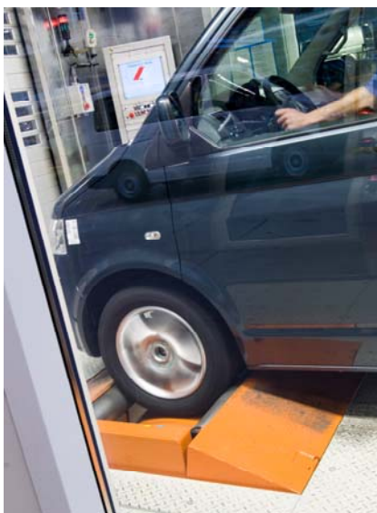
Abb. 2: Bis zu 130 Fahrzeuge werden pro Tag auf unerwünschte Geräusche hin untersucht, wozu Rüttelrollen mit unterschiedlich hohen Belägen unterschiedliche Fahrbahnverhältnisse simulieren
