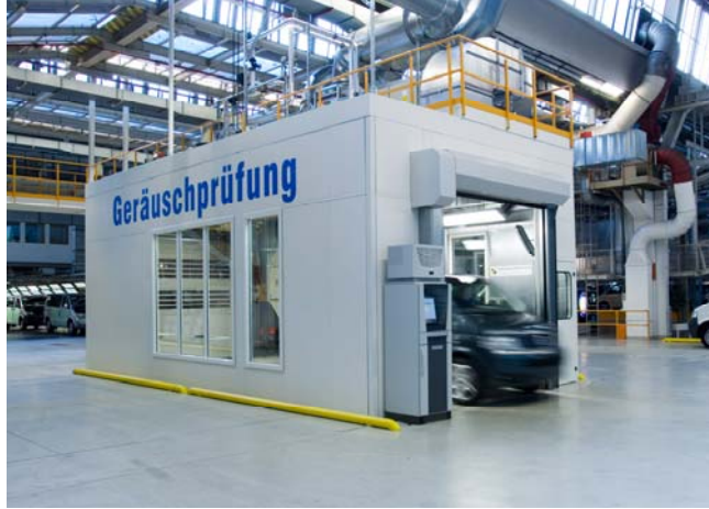
Abb. 1: Von der Straße in die Halle verlegt hat Volkswagen Nutzfahrzeuge im Werk Hannover die Geräuschprüfung für diverse Varianten der aktuellen Modellreihe T5
