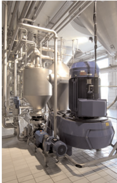
Bild 4: Eine Steigerung der Produktivität gelang mit einer neuen Hefe-Zentrifuge im Rahmen des Projektes „Hefebierückgewinnung“. Die neue Funktionalität wurde zusätzlich in die neue CPU 417 integriert.
