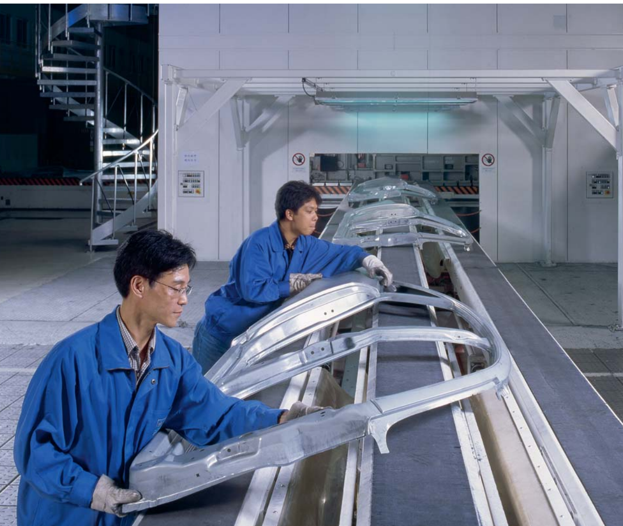
Die neue Pressenlinie wird große Karosserieaußenhautteile wie Kotflügel, Türen und Dächer fertigen, wie hier eine vergleichbare Anlage bei FAW-VW, Changchun
