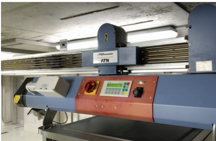
Das Simatic Operator Panel OP3 an den Fahrwerken ermöglicht einfaches Bedienen und visualisiert aktuelle Betriebsdaten.
