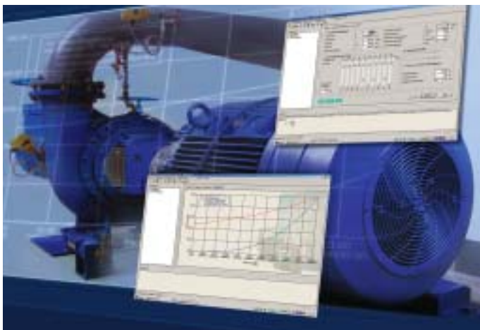
Das PC-Programm Sinasave berechnet anhand anlagenspezifischer Kenn-daten den Energiespareffekt von Energiesparmotoren oder Frequenzumrichtereinsatz sowie der Amortisationszeit für eine solche Investition – sie beträgt oft nur einige Monate.
