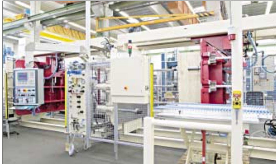
Die bislang größte von Dorst Technologies entwickelte Druckgussmaschine DG180Z produziert auf zwei Pressenmodulen nebeneinander großformatige sanitär-keramische Produkte.
