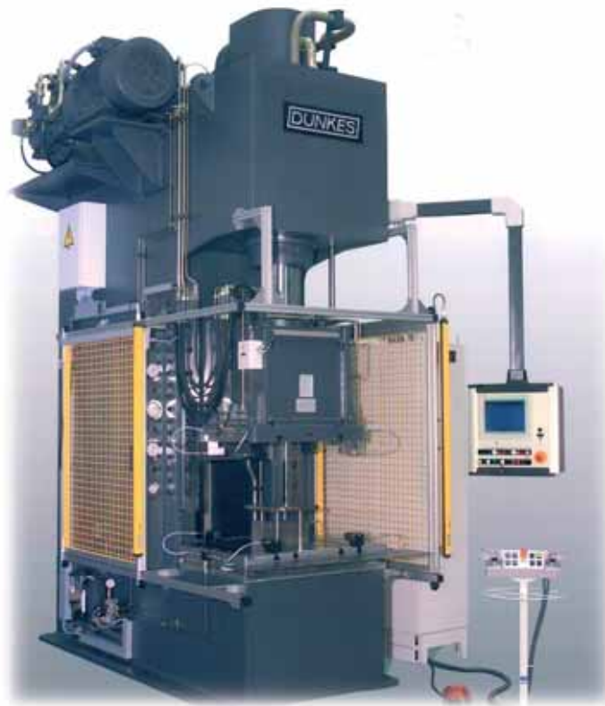
Bild1: Diese Einständer-Tiefzieh- presse HEZ 160 von Dunkes ist eine Universalmaschine mit einer Presskraft von 1 600 kN und einem Hub von 600 mm.
