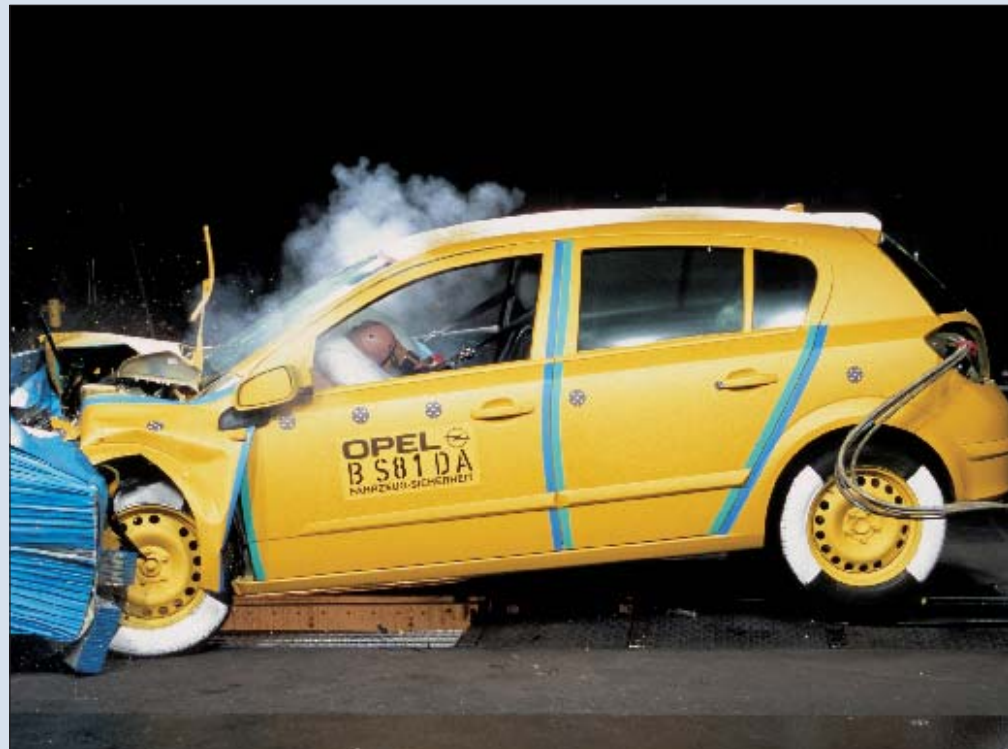
Bei Opel fahren die Crashtest-Fahrzeuge frontal auf eine Barriere.
