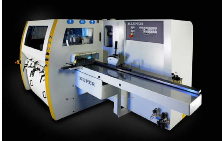
Abb. 1: Die neue Generation der Hobel- und Kehlautomaten Kuper SWT zeichnet sich durch ein einfaches, aber wirksames Sicherheitskonzept aus, das auf dem multifunktionalen Sicherheitsschaltgerät SIRIUS 3TK28 basiert
