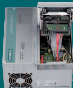
Einfache Wartung: Für den schnellen Zugriff auf die Festplatten müssen nur vier Gehäuseschrauben gelöst werden.
